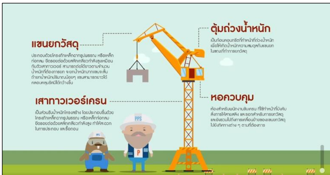
รูปที่ 2.13.3-1 ทาวเวอร์ เครน (Tower crane) แบบบูมกระดก (Luffing Jib Crane)
